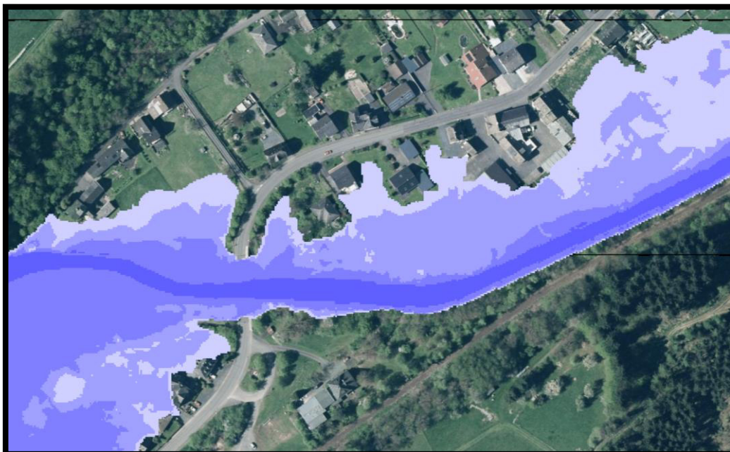
Seelbach, Bereich Bahnhofstraße, Wasserspiegellage bei HQ 100
