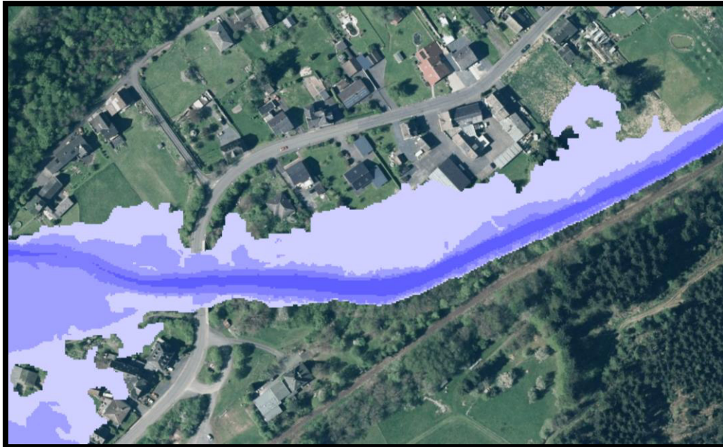
Seelbach, Bereich Bahnhofstraße, Wasserspiegellage bei HQ 10
